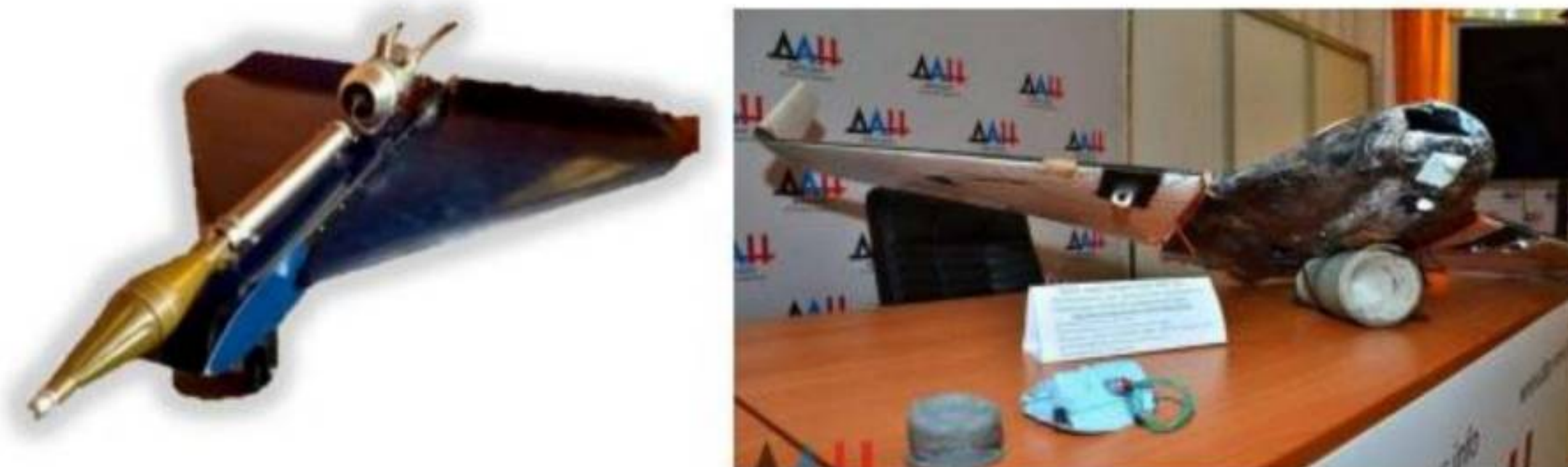
Сүр. 2. Қолдан жасалған РПГ-ге ату арқылы ҰҰА (сол жақта) және қытайлық өндірістегі коммерциялық ҰҰА, салмағы 3,5 кг (оң жақта) (Украина) кумулятивтік заряды КЗ-6 SM-2.
